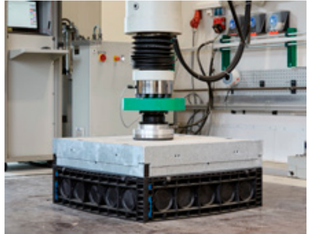
▲ Prüfung der Belastungsklasse bei Langmatz in Garmisch-Partenkirchen
