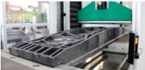
▲ 3-Punkt-Prüfpresse bei Langmatz in Oberau
