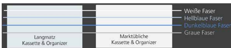
▲ Farbkontrast der Langmatz Kassetten- und Organizer zur besseren Erkennbarkeit heller Fasern
