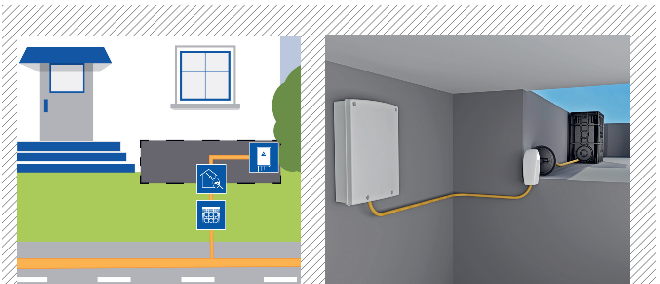
▲ Homes Connected mit dem Langmatz Gf-Übergabesystem
