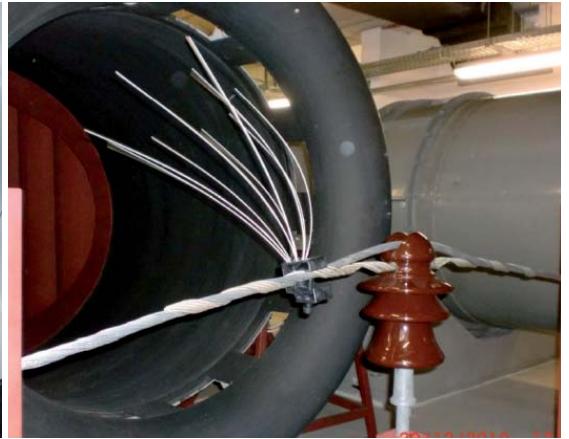
Windfestigkeitsprüfung an der Fachhochschule Mannheim, bis zu einer Windgeschwindigkeit von 250 km/h
