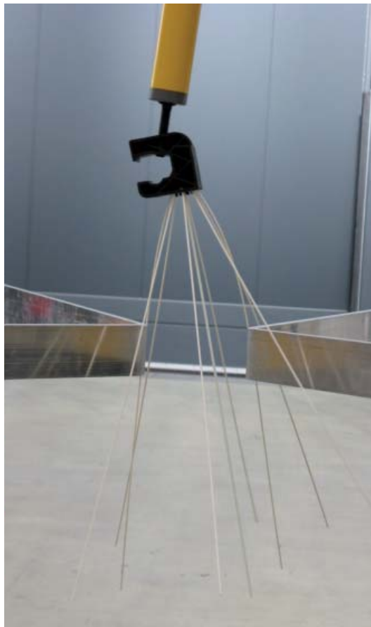
Elektrische Typprüfung einer Montagegestange für Büschelabweiser für eine Nennspannung bis 36 KV, bei der TU in Dresden
