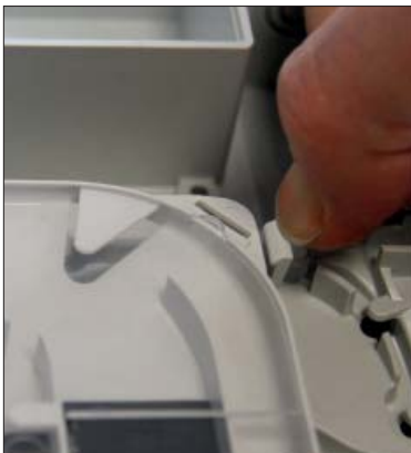
Abb. 12 Beim Öffnen der Kassette Rasthaken zurückziehen
